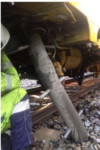
Oude seinpaal onder stopmachine terecht komen, vast in bodem van machine (foto: BAM Infra Rail)
