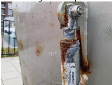
Afbeeldingen 2 en 3. Gasveer (deksel in open stand)
