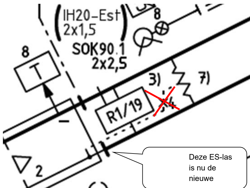
Uitvergroting 2: gebied rondom nieuwe tijdelijke scheiding met te verbreken verbinding
